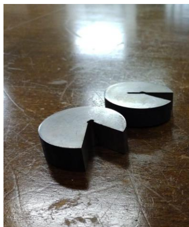
Figura 17 - Corte das seções destinadas à análise metalográfica e MEV.
