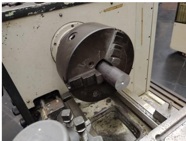
Figura 29 - Material fixado no torno com o faceamento e furo de centro prontos.
