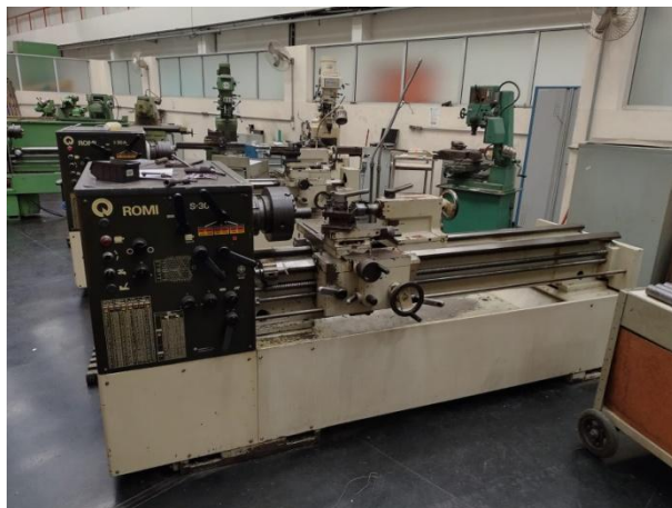
Figura 22 - Torno utilizado para a usinagem dos corpos de prova e testes em dinamômetro.
