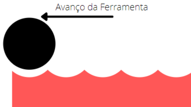
Figura 56 - Representação do rastro deixado pela ferramenta.
