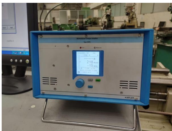
Figura 23 - Modelo do amplificador de sinal utilizado.
