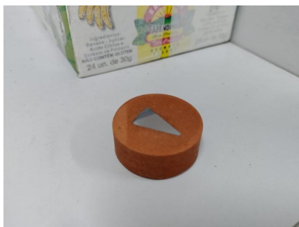
Figura 18 - Corpo de prova pronto para a análise metalográfica e MEV.
